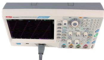
2. 连接被测信号至UT-M15：用户可以根据测试需要将任意数量( $\leq 16$ )的被测信号连接至UT-M15，连接时需要注意，输入信号的幅度不能超过探头的最大工作电压范围。为适应不同的应用场合，UT-M15提供了三种与被测信号的连接方法。
