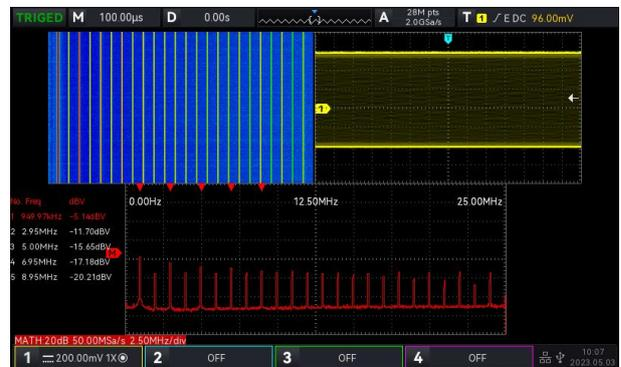
可以设置频率范围、检波模式和频谱标记、瀑布图、自动标记峰值、用户预置等类频谱的实用功能，便于对信号进行频域分析。
