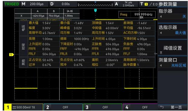
在打开 Cursor 的情况下，可对光标区域内的波形进行参数测量，方便用户对指定区域的波形测量，增加测量区域的灵活性和可操作性。
