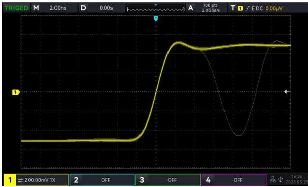
采用的创新数字信号并行处理技术，正常采样可达 150,000wfms/s 超高捕获率，捕获偶发信号。（在 Fast Acquire 模式可达 300,000 wfms/s）。
