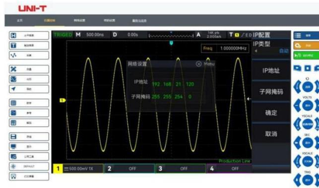
内嵌 Web Server，通过浏览器即可对仪器进行远程控制、观察波形、获取测量结果，可应用在远程监控、远程办公、数据分享等场景。无需安装驱动软件 and 上位机软件，即可实现跨平台操控。UPO1204X-E 内嵌的虚拟控制面板和示波器面板完全相同，支持 PC 的网页布局，使用起来更加简单方便。
