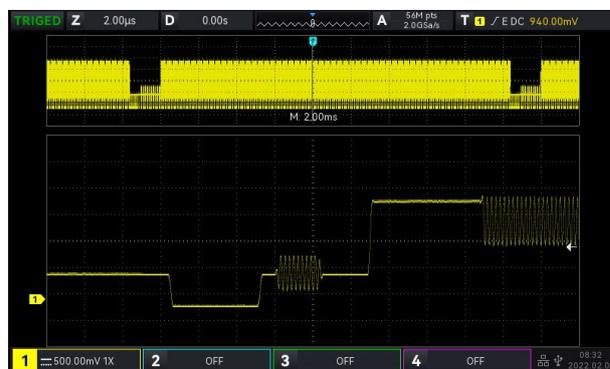
便于示波器能在更宽的时基范围能保持高采样率, 同时兼顾波形的整体和细节, 大大提升了异常波形捕获率。
