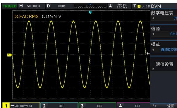
UPO1204X-E 示波器内置数字电压表（DVM），符合或超出指定限值范围后发出警告，可以为用户提供更精确的测量，从而全面提升用户的计数测量体验。
