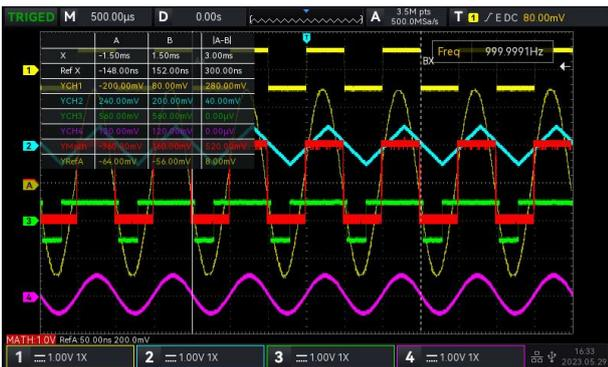
可同时对 CH1、CH2、CH3、CH4、MATH、REF 的时间和电压进行测量。
