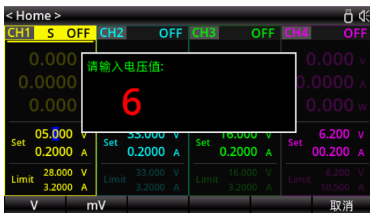
图 4-1 电压数字按键输入界面
