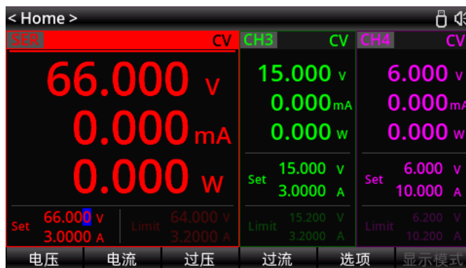
图 5-2 串联显示界面
